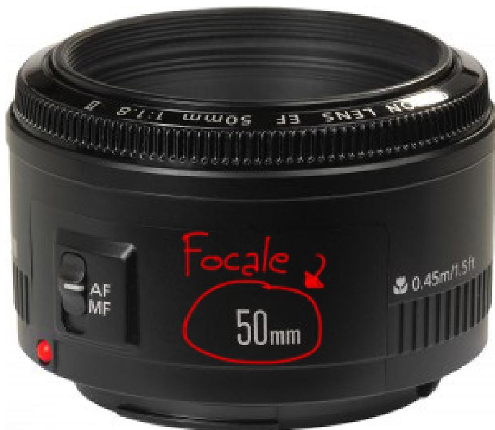
La lunghezza focale è inoltre importante per determinare la dimensione nel sensore del soggetto che fotografate: se con un 50mm riempi il fotogramma con un viso ad una distanza di 1 metro, per ottenere la stessa immagine con un'ottica da 100mm dovrai indietreggiare a 2 metri dal soggetto, se invece utilizzi un'ottica da 200mm la distanza da tenere per ottenere la stessa dimensione del soggetto nel nostro sensore sarà di almeno 4 metri.
