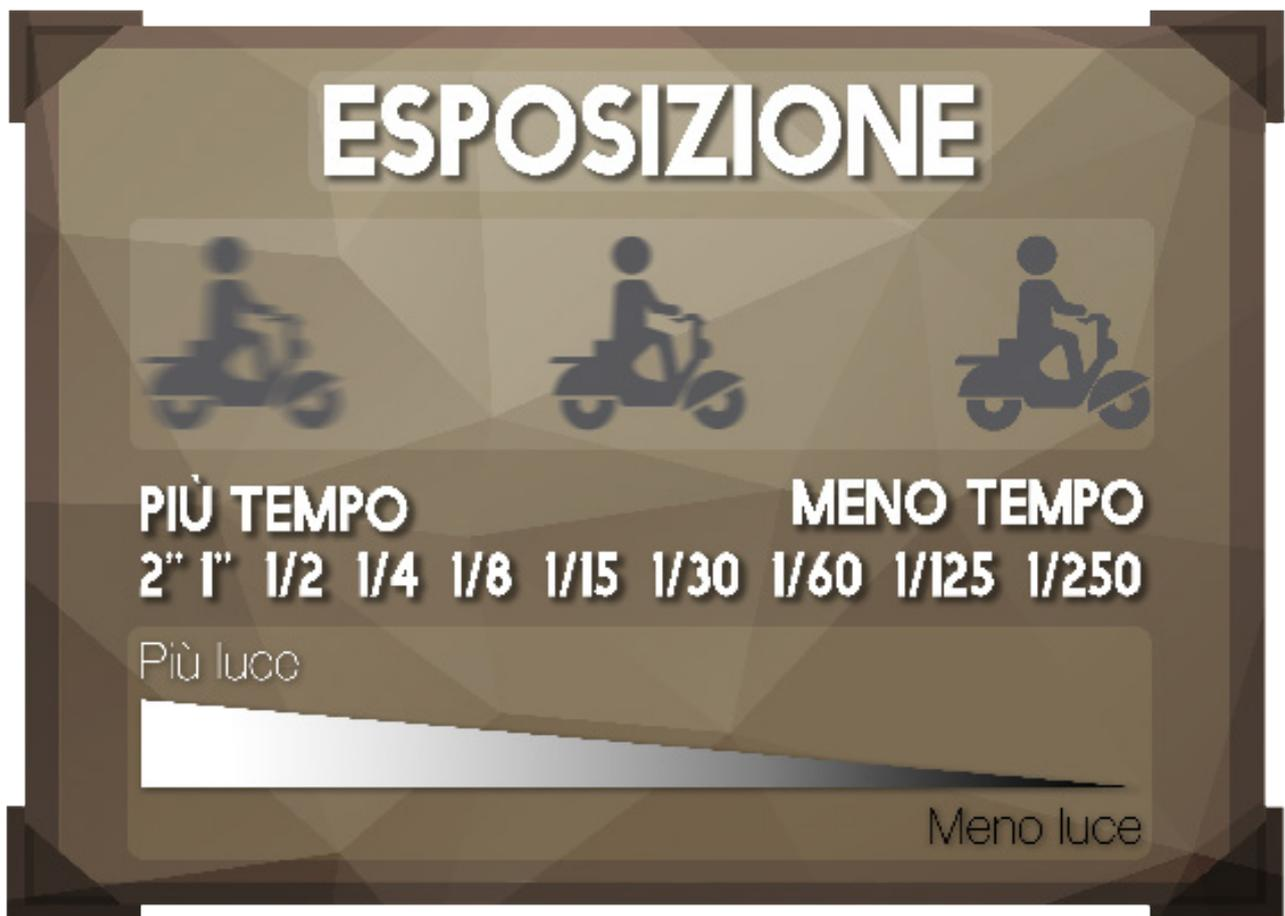
Ogni fotocamera ha le proprie impostazioni, e solitamente è possibile incrementare o diminuire la velocità di scatto (tempo si posa) di 1/2 o 1/3 di stop alla volta.
